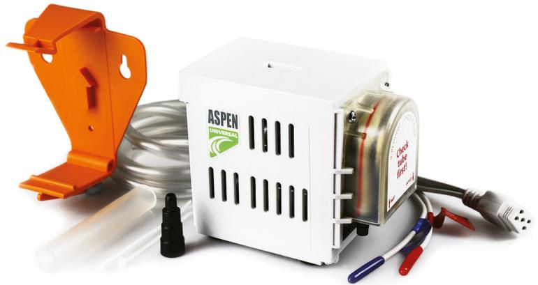
Die beliebte Universal-Pumpe arbeitet mit zwei Lufttemperatursensoren. Die Drehbewegung der Schlauchpumpe erzeugt einen gleich bleibenden Unterdruck, daher kann die Pumpe ohne jeden Leistungsverlust 3 m geodätisch das Kondensat ansaugen.
