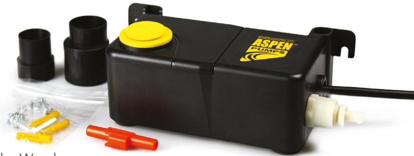
Die neue und verbesserte Mini Tank-Pumpe kann an der Wand, am Boden, in der Wanne oder an einer M8/M10 Gewindestange hängend montiert werden. Dank der Kolbentechnik ist die Pumpe kompakt, leistungstark und multifunktional.
