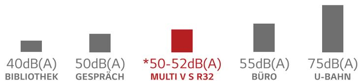
\*12,1 kW: 50dB(A), 14 kW: 51dB(A), 15,5 kW: 52dB(A)
